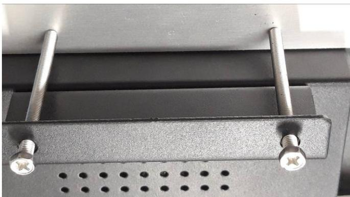
Mit den M5x70mm Schrauben wird das Bedienmodul in der Front fixiert.
