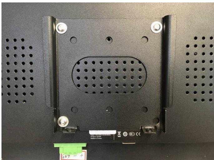
Die Halterung wird am Bedienmodul mit drei M4x6mm Schrauben befestigt.
